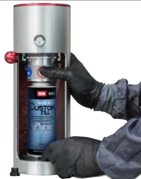
Relleno de un envase de aerosol con Custom Fill Pneumatic Machine
